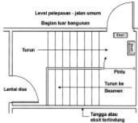
Contoh 3.41 – Penghentian tangga eksit pada level eksit pelepasan. (sebagai penjelasan tambahan butir 3.14.3)
